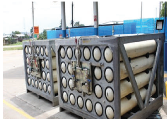
GTM Mini Industry Capacity : 500 sm 3
