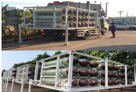
GTM Mini Industry GTM : 10 Feet (MODULAR) Capacity : 1.200 sm 3 Cylinder : TYPE 2
